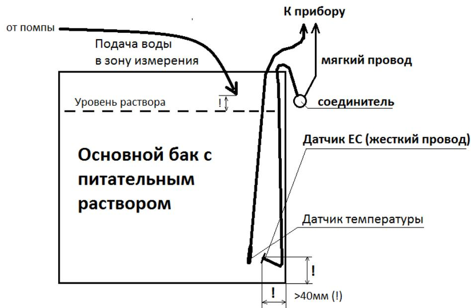
Необходимо обеспечить расстояние от ЕС электрода до любой поверхности не менее 40 мм! Термометр необходимо расположить на высоте датчика ЕС.
